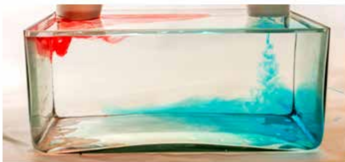
Σχήμα 8: Θερμό κόκκινο και ψυχρό μπλε νερό διοχετεύονται στο δοχείο
